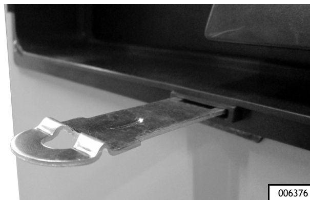
Рисунок 3-7. Установка накладки с пробоем на смотровое окно
